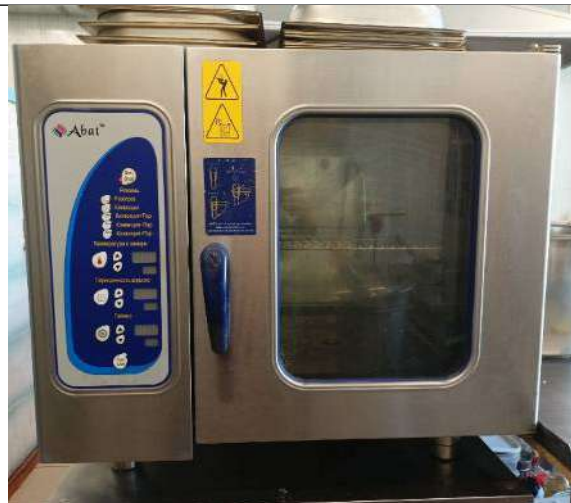
Пароконвектомат ПКА 6-1/1ВМ (впрыск)
